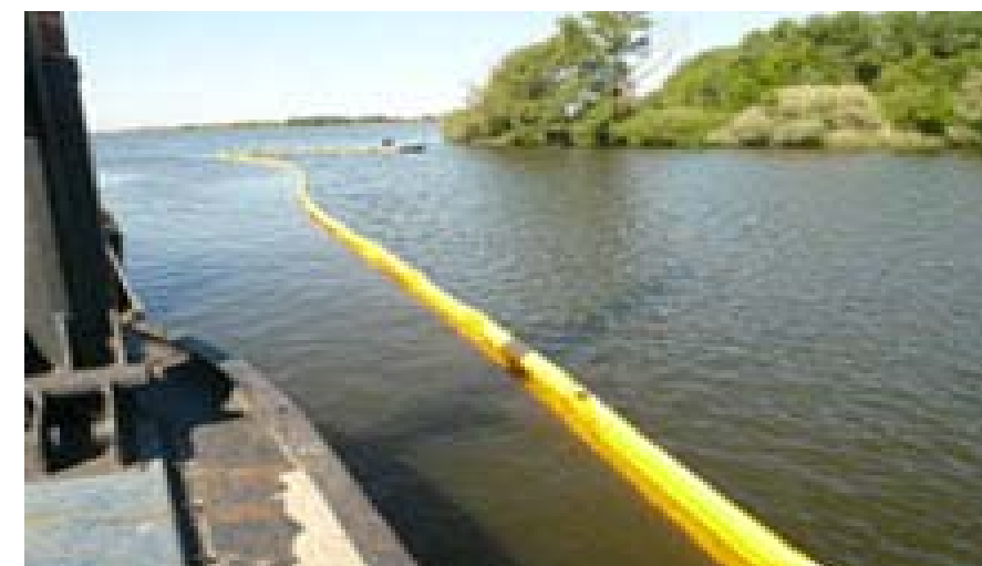
Un barrage flottant (en jaune). Les centres de Kribi, Douala et Limbé en seront dotés
