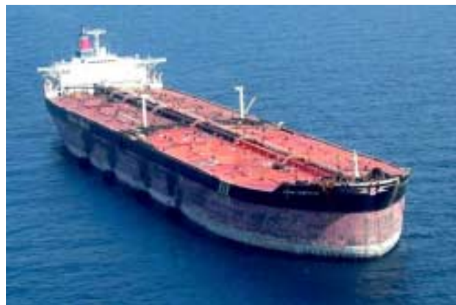
Ce navire tanker mesure 360 m de long et 60 m de large, avec un tirant d'eau de 23 m. Il a une capacité de stockage de 2 millions de barils de pétrole brut.
