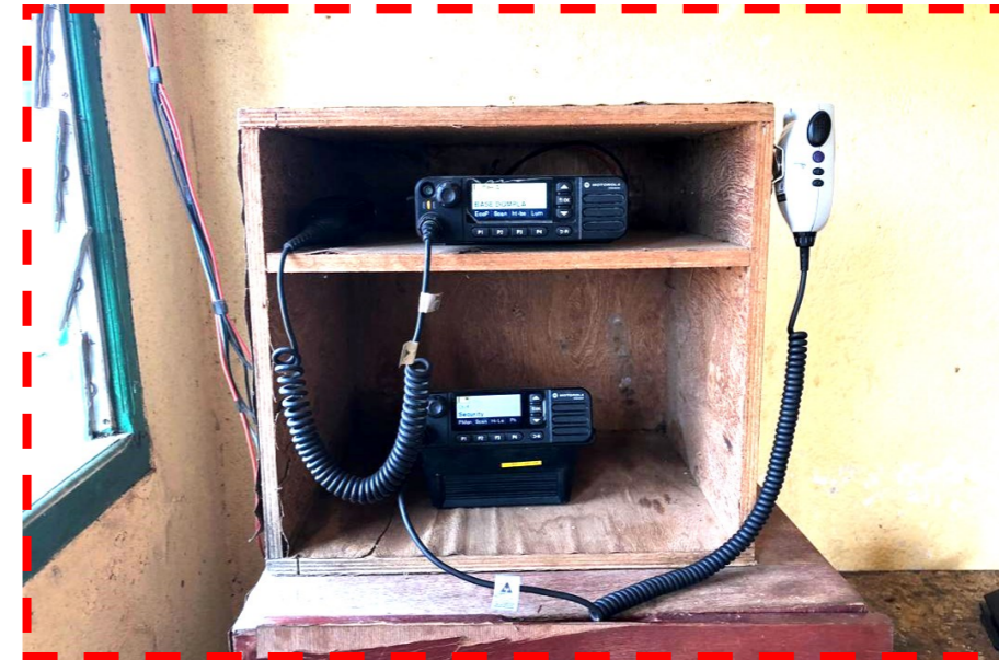
Des émetteurs utilisés par le SED pour assurer une bonne fluidité des télécommunications entre les Unités de Gendarmerie situées le long du Pipeline Tchad/Cameroun
