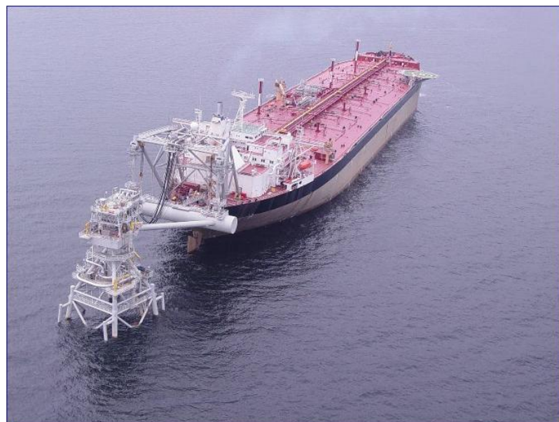
Le Terminal pétrolier Komé-Kribi. Au 1 er plan, le point d'amarrage de ce bateau long de 360 m et large de 60 m, à 12 km au large de Kribi
